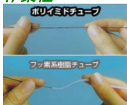
フッ素系樹脂チューブとポリイミドチューブとの線通し作業性の比較。フッ素系樹脂チューブは先が曲がりやすく、滑らかに線が通りません。
